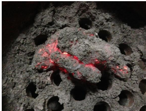
ภาพที่ 2.18 การเผาไหม้ของถ่านแท่งที่ 1 ชั่วโมง 45 นาที
