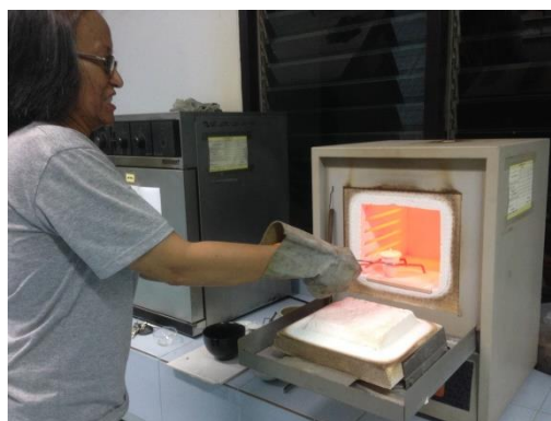
ภาพที่ 2.21 การอบขึ้นทดสอบในเตา
