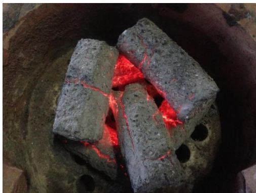
ภาพที่ 2.13 การเผาไหม้ของถ่านแท่งที่ 30 นาที
