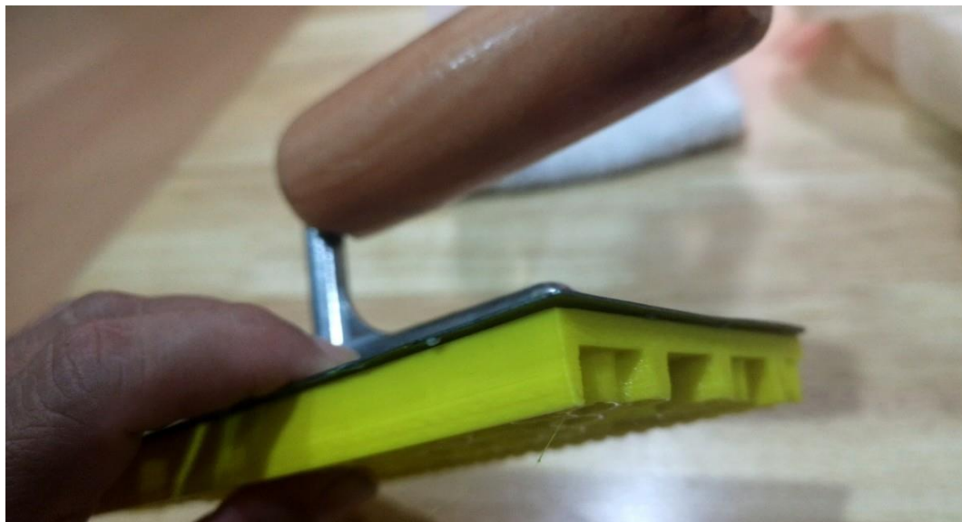
ภาพที่ 4-19: หูจับเหล็กที่ไม่เสมอพอดีกับตัวพิมพ์ รวมถึงลักษณะด้ามจับที่ทำให้ขาดสมดุลย์ของแรงกด ที่มา: ผู้วิจัย และคณะ, 2563
