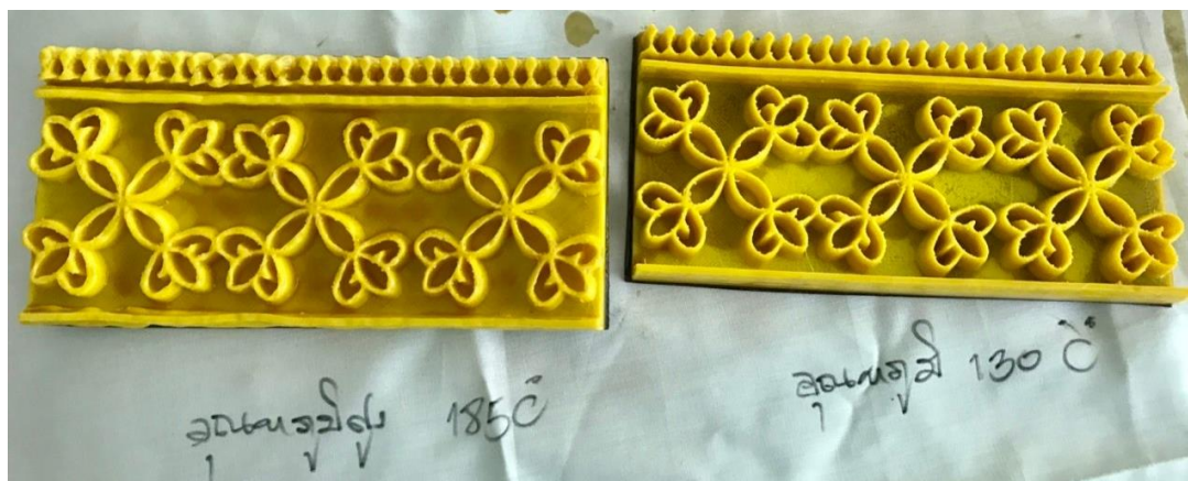
ภาพที่ 4-21: เปรียบเทียบผลของอุณหภูมิที่มีผลต่อการเสีรูปของบล็อกพิมพ์
