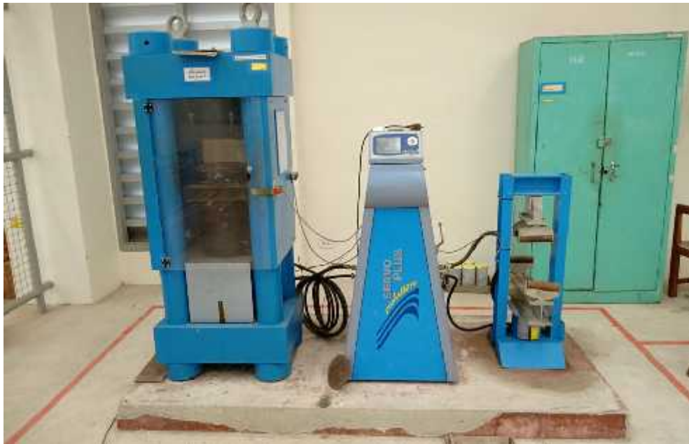
รูปที่ 3.22 เครื่องทดสอบหาค่ากำลังอัดของคอนกรีต (Universal testing machine)
