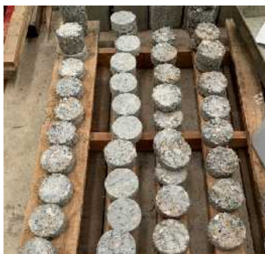
รูปที่ 3.15 แท่งตัวอย่างรูปทรงกระบอกทดสอบการต้านทานการแทรกซึมของคลอไรด์
