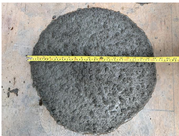
รูปที่ 4.8 การไหลแผ่ของคอนกรีตสด
