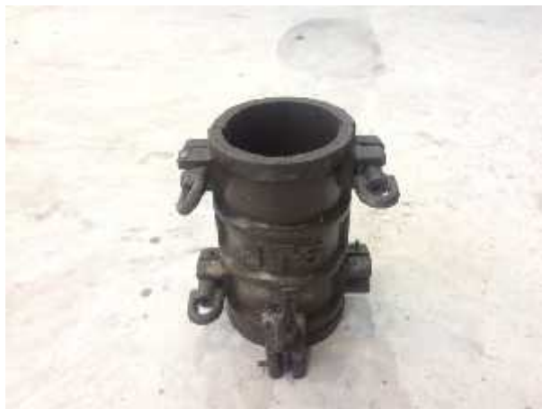
รูปที่ 3.11 แบบหล่อคอนกรีตรูปทรงกระบอกขนาดเส้นผ่านศูนย์กลาง 100 mm สูง 200 mm
