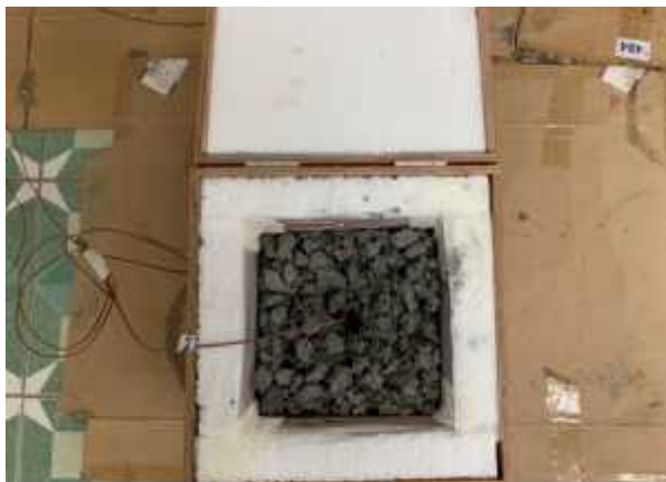
รูปที่ 3.14 ก้อนตัวอย่างคอนกรีตทดสอบความร้อนของปฏิกิริยาไฮเดรชัน
