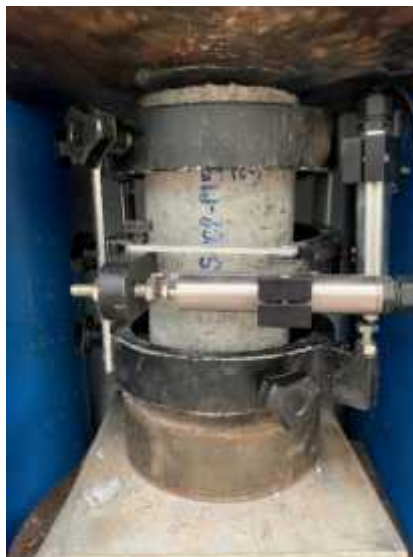
รูปที่ 3.23 เครื่องทดสอบโมดูลัสยืดหยุ่นของคอนกรีต
