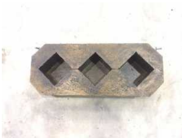
รูปที่ 3.10 แบบหล่อมอร์ต้าร์รูปทรงลูกบาศก์ ขนาด 50 \times 50 \times 50 mm
