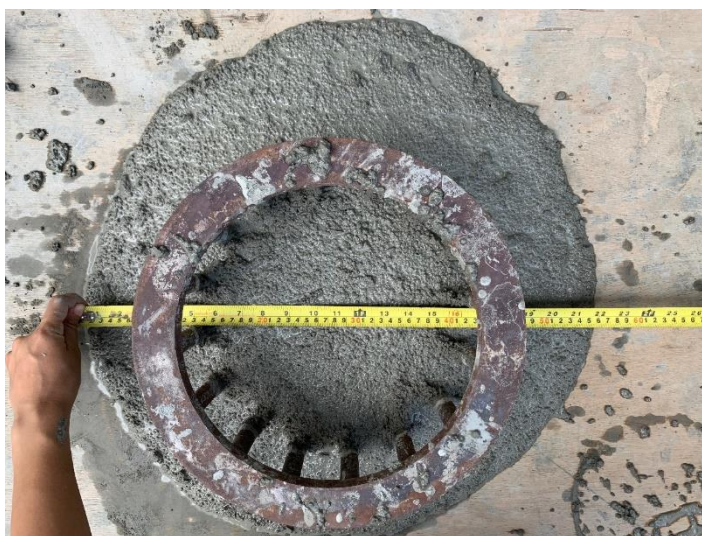
รูปที่ 4.1 การทดสอบการไหลผ่านสิ่งกีดขวางซี่เหล็ก
