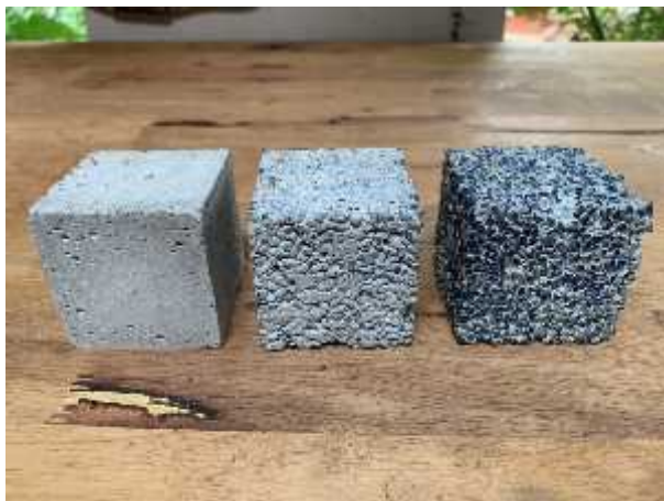
รูปที่ 3.12 แท่งตัวอย่างรูปทรงลูกบาศก์ขนาด 50 × 50 × 50 mm
