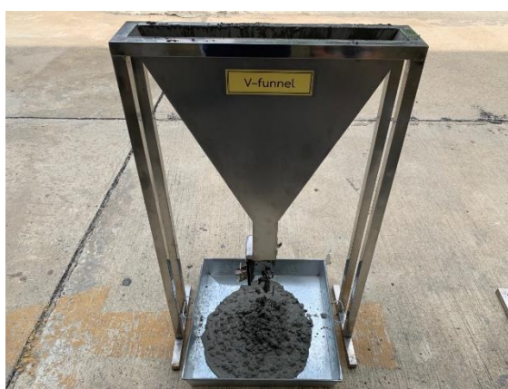
รูปที่ 4.12 การทดสอบความหนืดของคอนกรีตสด
