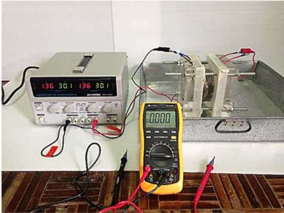
รูปที่ 3.28 เครื่องมือทดสอบการต้านทานการแทรกซึมคลอไรด์ของคอนกรีต
