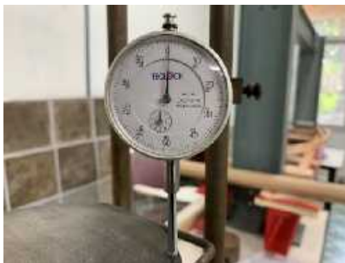
รูปที่ 3.5 Dial gage ความละเอียด 0.01 mm
