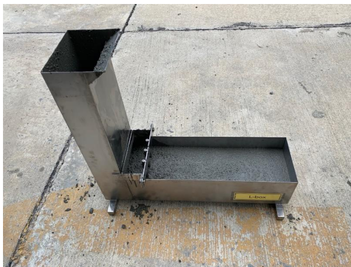
รูปที่ 4.15 การทดสอบการไหลผ่านสิ่งกีดขวางในแนวนอน
