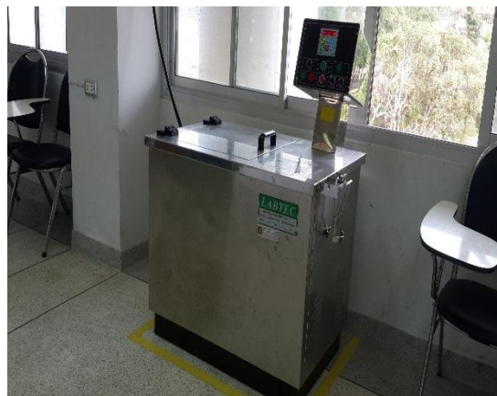
รูปที่ 4.13 เครื่องย้อมเส้นด้าย
