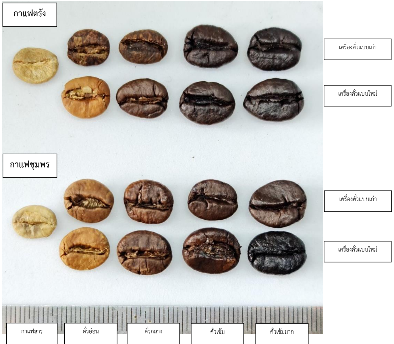
รูปที่ 4.5 ลักษณะเมล็ดกาแฟโรบัสต้าตรังและชุมพรที่ระดับการคั่วต่างกันด้วยเครื่องคั่วโองแบบเดิมและเครื่องคั่วโองแบบใหม่
