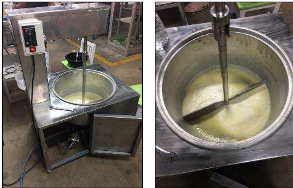
รูปที่ 3.28 แสดงการใช้งานเครื่องกวนผลไม้ควบคุมด้วยระบบอัตโนมัติ
