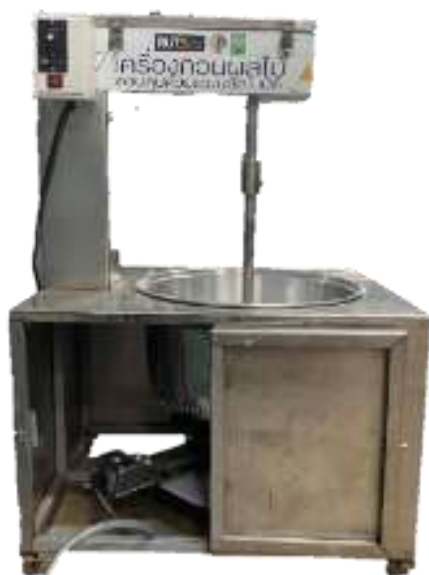
รูปที่ 3.14 ลักษณะของโครงสร้างของเครื่องกวนผลไม้ควบคุมด้วยระบบอัตโนมัติ
