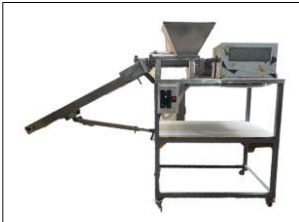
รูปที่ 3.17 ลักษณะของโครงสร้างของเครื่องอัดแท่งผลไม้กวน
