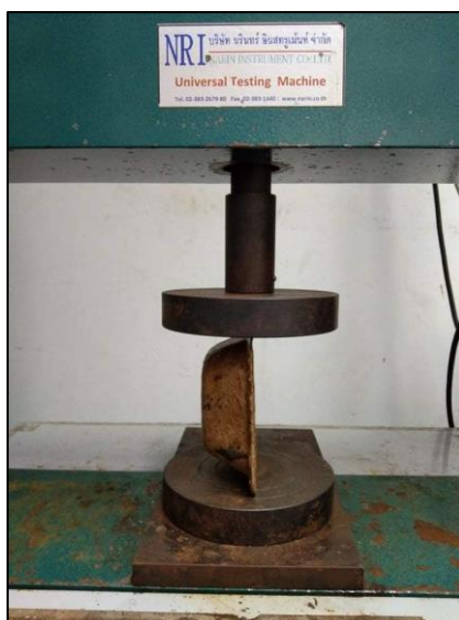
รูปที่ 3.67 การทดสอบความต้านทานแรงกดอัดทางด้านข้างของบรรจุภัณฑ์จากเส้นใยกาบมะพร้าวผสมผงพอลิเอทิลีน (HDPE)
