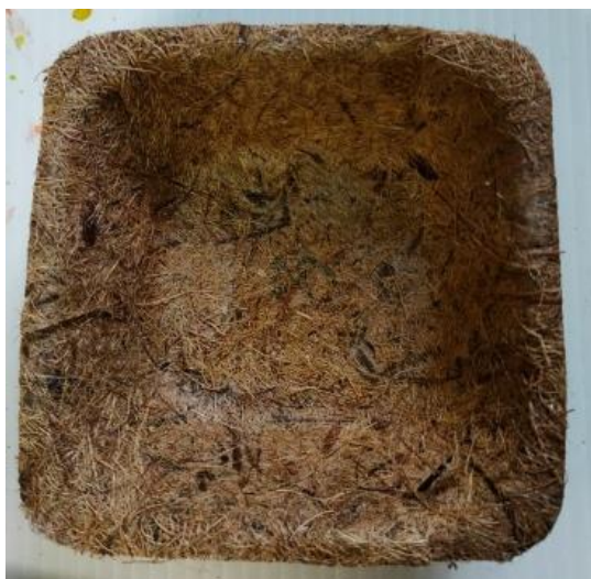
รูปที่ ข.10 บรรจุภัณฑ์จากเส้นใยกาบมะพร้าวผสมผงพอลิเอทิลีน (HDPE) ที่อุณหภูมิ 170 องศาเซลเซียส 8 นาที
