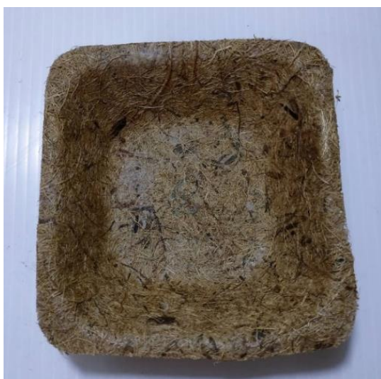
รูปที่ ข.9 บรรจุภัณฑ์จากเส้นใยกาบมะพร้าวผสมผงพอลิเอทิลีน (HDPE) ที่อุณหภูมิ 170 องศาเซลเซียส 4 นาที
