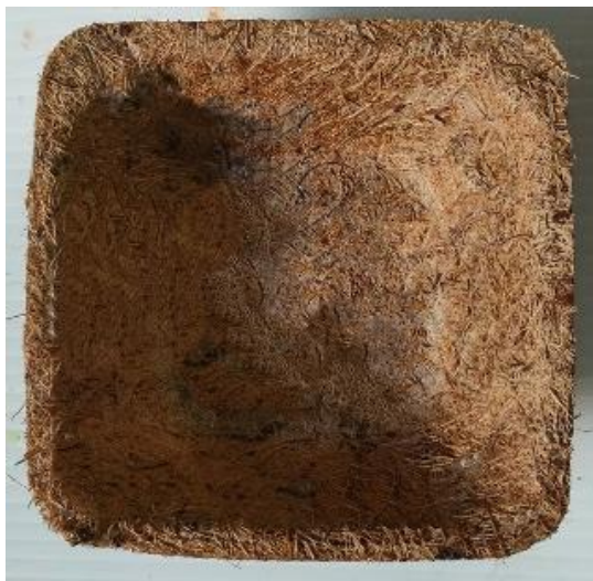
รูปที่ ข.9 บรรจุภัณฑ์จากเส้นใยกาบมะพร้าวผสมผงพอลิเอทิลีน (HDPE) ที่อุณหภูมิ 170 องศาเซลเซียส 6 นาที
