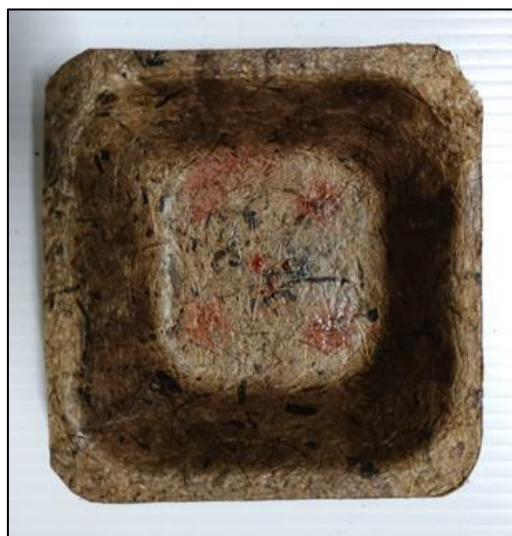
รูปที่ 3.69 การทดสอบดูดซึมน้ำของบรรจุภัณฑ์จากเส้นใยคาบมะพร้าวผสมผงพอลิเอทิลีน (HDPE)
