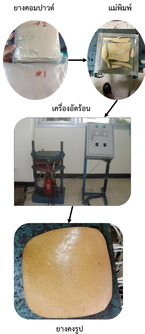
รูปที่ 3.27 ขั้นตอนการทำให้ยางคงรูปด้วยความร้อน
