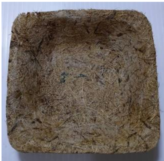
รูปที่ ข.7 บรรจุภัณฑ์จากเส้นใยกาบมะพร้าวผสมผงพอลิเอทิลีน (HDPE) ที่อุณหภูมิ 150 องศาเซลเซียส 4 นาที
