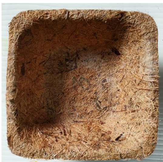
รูปที่ ข.8 บรรจุภัณฑ์จากเส้นใยกาบมะพร้าวผสมผงพอลิเอทิลีน (HDPE) ที่อุณหภูมิ 150 องศาเซลเซียส 6 นาที
