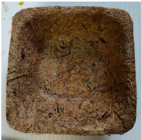
รูปที่ ข.9 บรรจุภัณฑ์จากเส้นใยกาบมะพร้าวผสมผงพอลิเอทิลีน (HDPE) ที่อุณหภูมิ 150 องศาเซลเซียส 8 นาที
