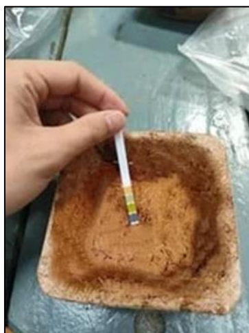
รูปที่ 3.71 การทดสอบค่าความเป็นกรด-เบสของบรรจุภัณฑ์จากเส้นใยจากมะพร้าวผสมผงพอลิเอทิลีน (HDPE)
