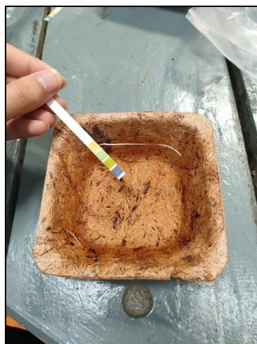
รูปที่ 3.70 การทดสอบค่าความเป็นกรด-เบสของบรรจุภัณฑ์จากเส้นใยจากมะพร้าว
