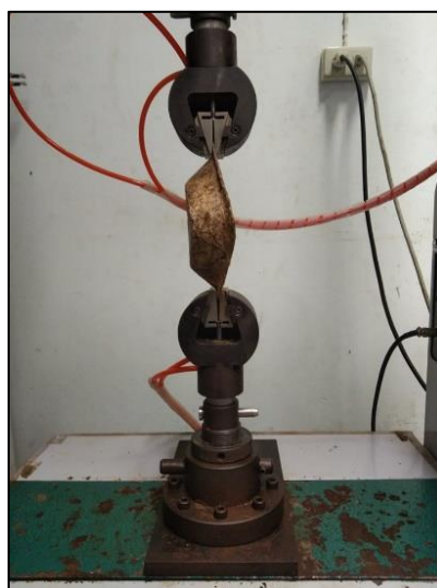
รูปที่ 3.63 การทดสอบความต้านทานแรงดึงบรรจุภัณฑ์จากเส้นใยกาบมะพร้าวผสมผงพอลิเอทิลีน (HDPE)
