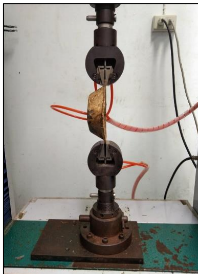
รูปที่ 3.62 การทดสอบความต้านทานแรงดึงบรรจุภัณฑ์จากเส้นใยกาบมะพร้าว
