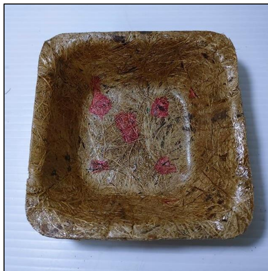
รูปที่ 3.68 การทดสอบดูดซึมน้ำของบรรจุภัณฑ์จากเส้นใยคาบมะพร้าว
