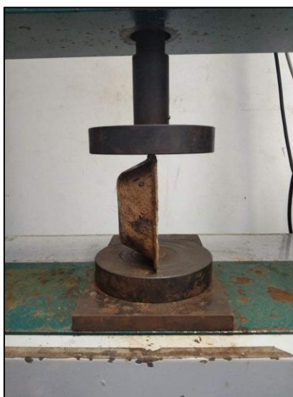
รูปที่ 3.65 การทดสอบความต้านทานแรงกดอัดทางด้านข้างของบรรจุภัณฑ์จากเส้นใยกามะพร้าว
