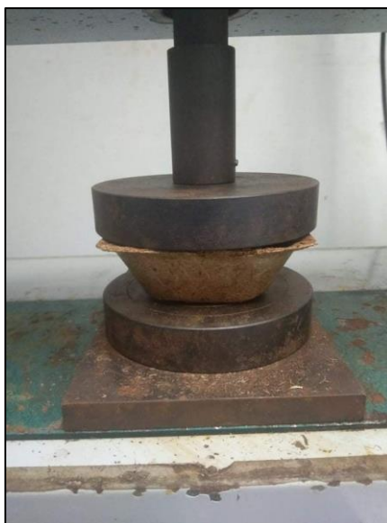
รูปที่ 3.66 การทดสอบความต้านทานแรงกดอัดทางด้านบนของบรรจุภัณฑ์จากเส้นใยกาบมะพร้าวผสมผงพอลิเอทิลีน (HDPE)
