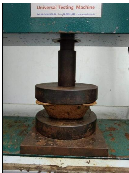
รูปที่ 3.64 การทดสอบความต้านทานแรงกดอัดทางด้านบนของบรรจุภัณฑ์จากเส้นใยกามะพร้าว
