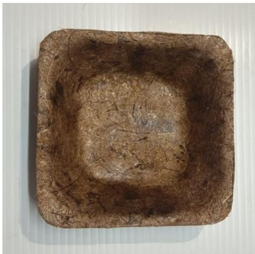
รูปที่ 4.39 บรรจุภัณฑ์จากเส้นใยคาบมะพร้าวผสมผงพอลิเอทิลีน (HDPE) ที่อุณหภูมิ 150 องศาเซลเซียส
