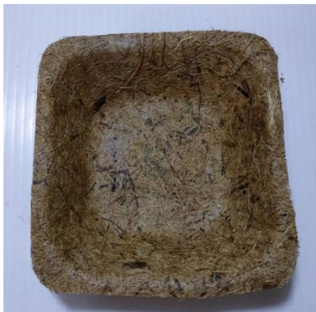
รูปที่ 4.22 บรรจุภัณฑ์จากเส้นใยกาบมะพร้าวผสมผงพอลิเอทิลีน (HDPE) ที่อุณหภูมิ 170 องศาเซลเซียส
