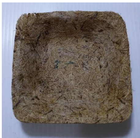
รูปที่ 4.21 บรรจุภัณฑ์จากเส้นใยคาบมะพร้าวผสมผงพอลิเอทิลีน (HDPE) ที่อุณหภูมิ 150 องศาเซลเซียส
