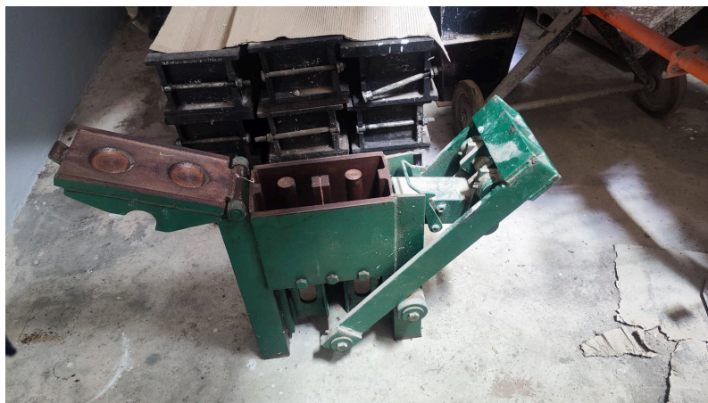
ภาพที่ 2-5 เครื่องอัดอิฐประสานด้วยแรงคน
