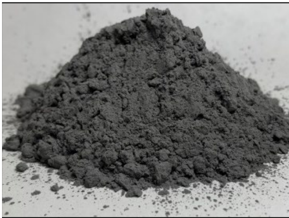
(e) ปูนซีเมนต์ปอร์ตแลนด์ประเภทที่ 1 (OPC)
