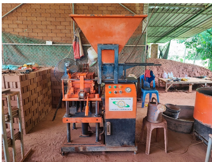
ภาพที่ 2-6 เครื่องอัดอิฐประสานแบบอุตสาหกรรมขนาดย่อม
