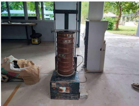
ภาพที่ 3-13 อุปกรณ์ชุดทดลองหาขนาดโดยใช้ ตะแกรง
