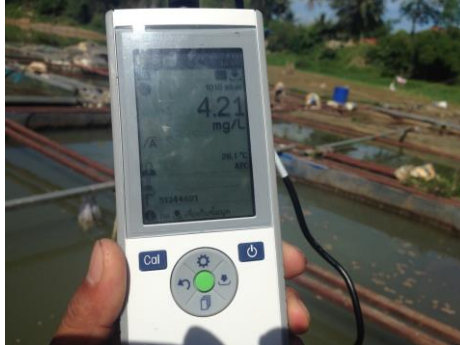
ภาพที่ 7 การตรวจหาค่าปริมาณออกซิเจนที่ละลายในน้ำ (Dissolve Oxygen : DO) กระชังที่ไม่มีเครื่องเติมอากาศ
