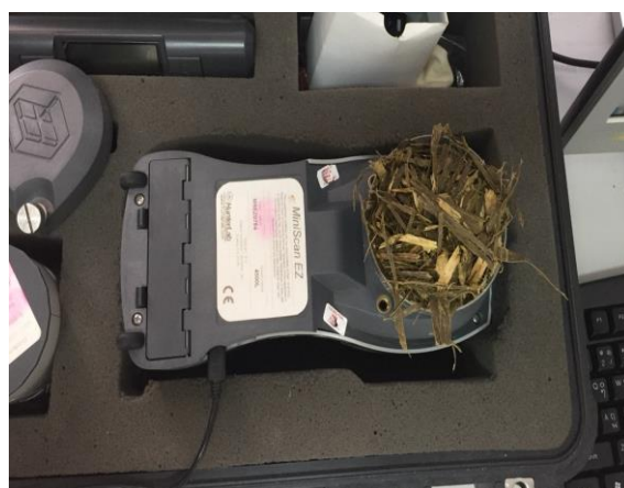
ภาพผนวกที่ 12 การวิเคราะห์สีของใบปาล์มหมัก ด้วยเครื่อง Mini Scan EZ
