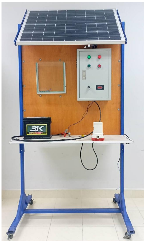
ภาพที่ 2 ชุดฝึกการควบคุมมอเตอร์ปั้มน้ำพลังงานแสงอาทิตย์
