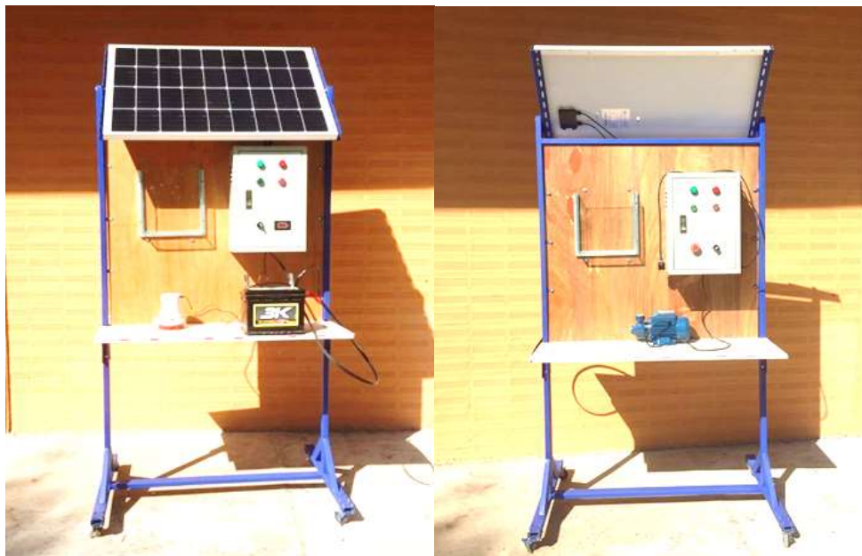
ภาพที่ 4-1 ชุดทดลองการควบคุมมอเตอร์ปั้มน้ำพลังงานแสงอาทิตย์
