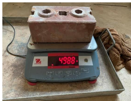
ภาพที่ 3.28 นำก้อนตัวอย่างแช่น้ำ 24 ชั่วโมง แล้วชั่งหามวล
