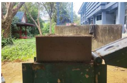
ภาพที่ 3.16 นำก้อนตัวอย่างออกจากเครื่องอัด
