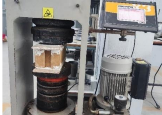
ภาพที่ 3.26 นำก้อนตัวอย่างเข้าเครื่องทดสอบ
