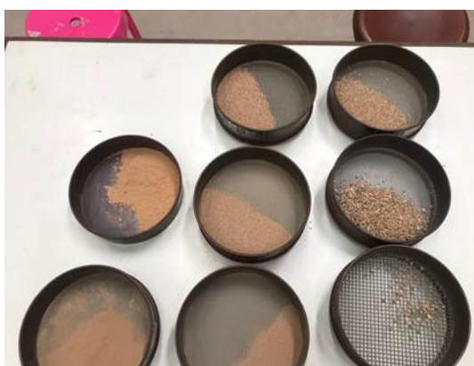
ภาพที่ 3.2 การทดสอบหาขนาดคละ และค่าโมดูลัสความละเอียดของดินลูกรัง
