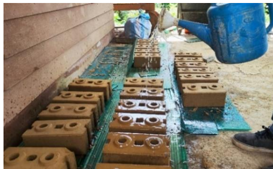
ภาพที่ 3.18 รดน้ำหรือฉีดพ่นน้ำที่อิฐบล็อกประสาน
