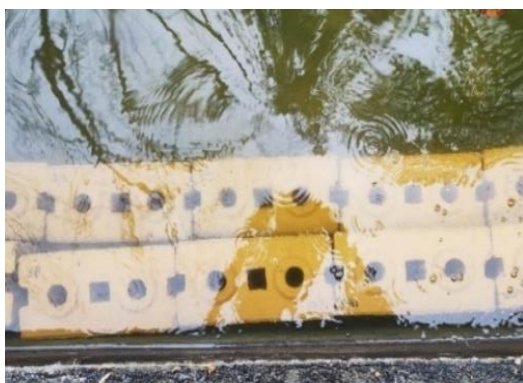
ภาพที่ 3.28 นำก้อนตัวอย่างแช่น้ำ 24 ชั่วโมง แล้วชั่งหามวล
