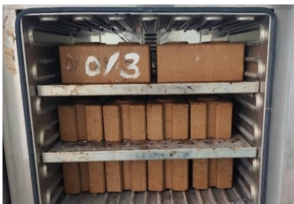
ภาพที่ 3.29 นำก้อนตัวอย่างอบความร้อน 24 ชั่วโมง แล้วชั่งหามวล
