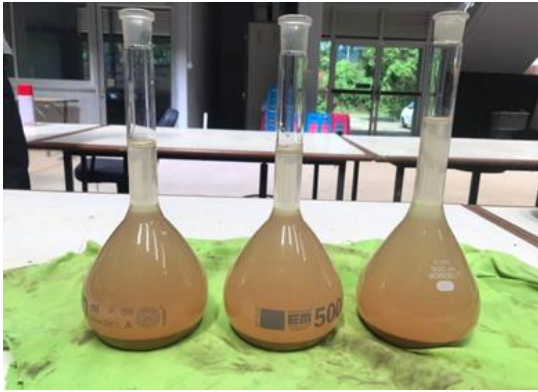
(a) การทดสอบหาค่าความถ่วงจำเพาะดินลูกรัง
