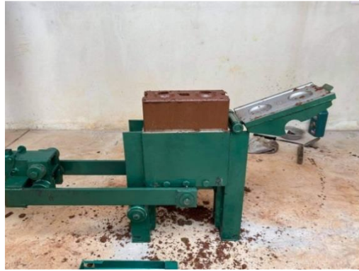
ภาพที่ 2.2 เครื่องอัดบล็อกประสานแบบชินวาแรม (แบบมือโยก)
