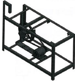
รูปที่ 3.2 ระบบส่งกำลังของเครื่องคัดแยกสิ่งเจือปนออกจากข้าวเปลือก
