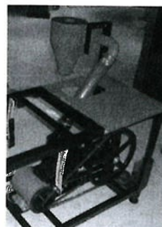
รูปที่ 3.4 ชุดโบลเวอร์ของเครื่องคัดแยกสิ่งเจือปนออกจากข้าวเปลือก
