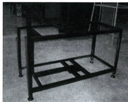
รูปที่ 3.1 โครงสร้างของเครื่องตัดแยกสิ่งเจือปนออกจากข้าวเปลือก
