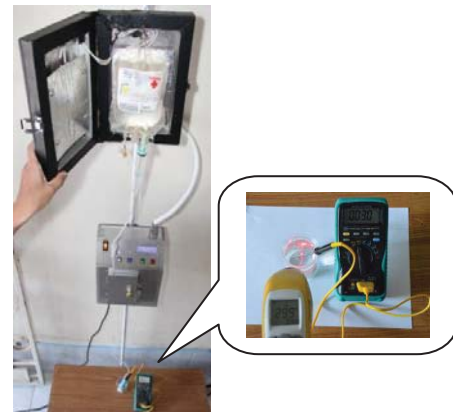
รูปที่ 7 การทดสอบการทำงานของเครื่องอุ่นเลือดฯ ด้วยอุ่นน้ำเมื่อกำหนดการทำงานที่อุณหภูมิต่างๆ
