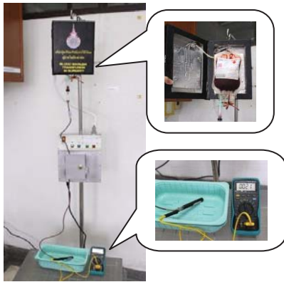
รูปที่ 9 การทดสอบการทำงานของเครื่องอุ่นเลือดฯ เมื่อกำหนดการทำงานของเครื่องที่อุณหภูมิ 45 องศาเซลเซียส
