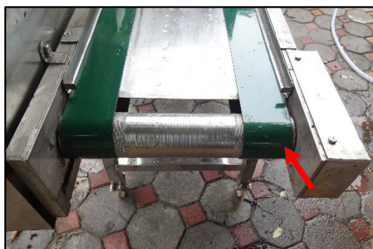
รูปที่ ข.1 ลักษณะความตึงที่เหมาะสมของสายพาน
