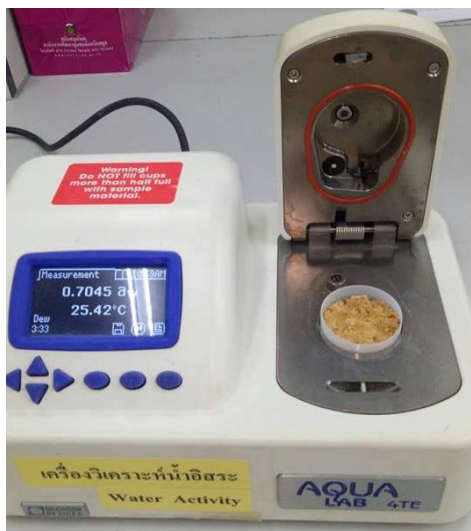
รูปที่ 4.4 การทดสอบค่า Water Activity ( a_w ) ของน้ำตาลแวน
