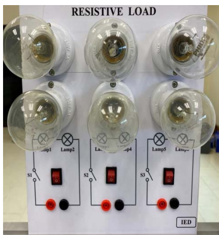
รูปที่ 3.31 โหลด Resistive ขนาด 40 W / 3 ชุด
