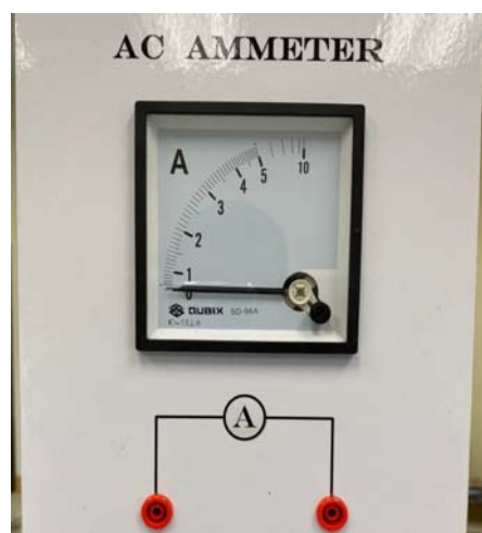
รูปที่ 3.23 AC Ammeter Panel ขนาด 10 A ช่วง 0-10 A
