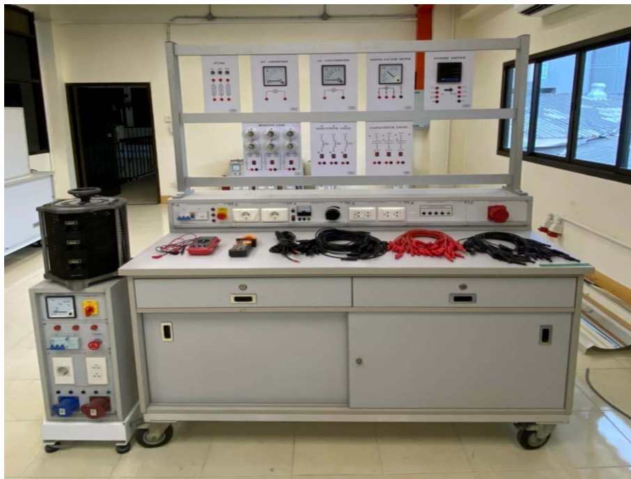
รูปที่ 3.12 ชุดทดลองระบบไฟฟ้า 1 เฟสและ 3 เฟส
