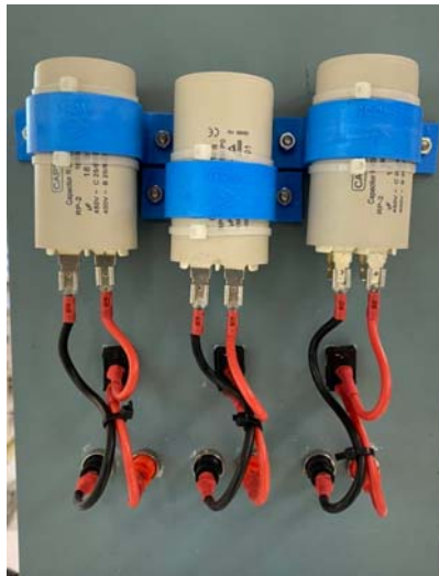
รูปที่ 3.19 Capacitive Load ใช้ขนาด 7.5 \mu\text{F} 450 V / 3 ชุด
