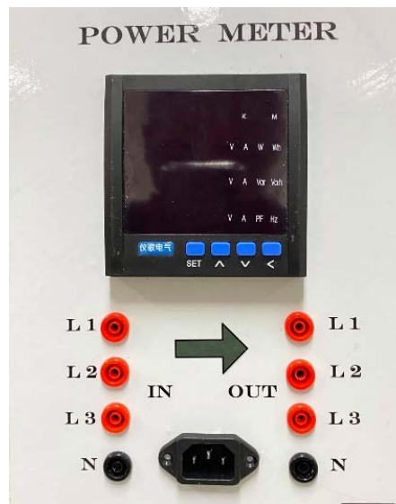
รูปที่ 3.22 Power Meter 3 เฟส รุ่น YG899E-AS4
