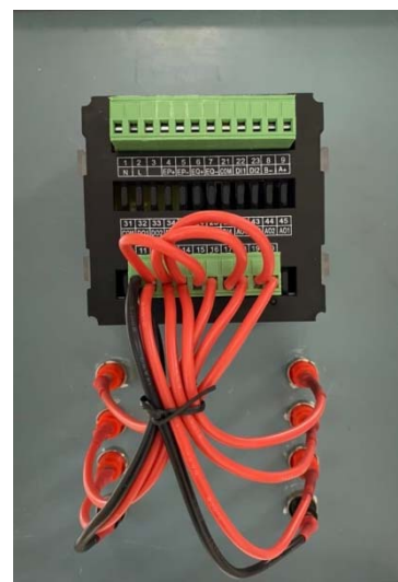
รูปที่ 3.16 พาวเวอร์มิเตอร์ 3 เฟส รุ่น YG899E-AS4
