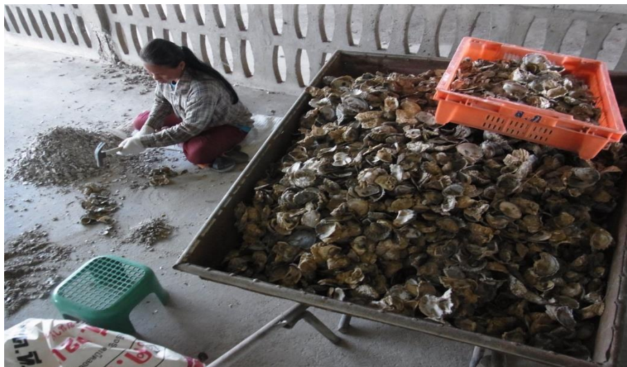
ภาพที่ 3-2ค ขั้นตอนการเตรียมเปลือกหอยนางรมที่คัดเลือกและทำความสะอาดแล้ว
