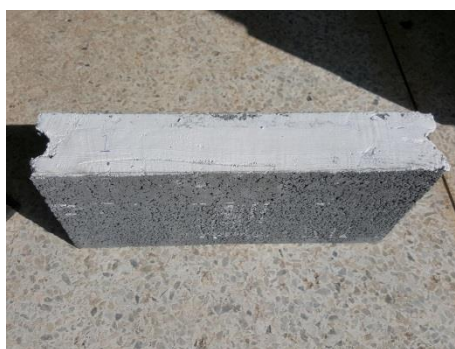
ภาพที่ 3-9 ปรับผิวหน้าคอนกรีตบล็อกด้วยปูนปลาสเตอร์ก่อนทดสอบกำลังรับแรงอัด
