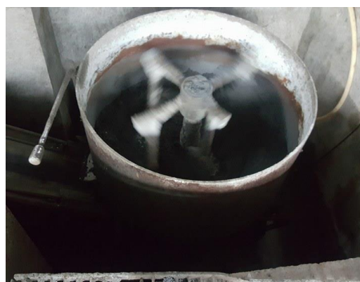
ภาพที่ 3-6 ผสมวัสดุต่างๆลงในเครื่องผสมคอนกรีตบล็อก
