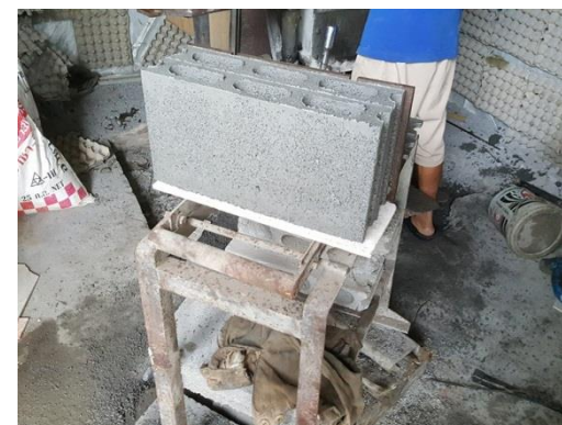
ภาพที่ 3-8 คอนกรีตบล็อกหลังจากอัดด้วยเครื่อง
