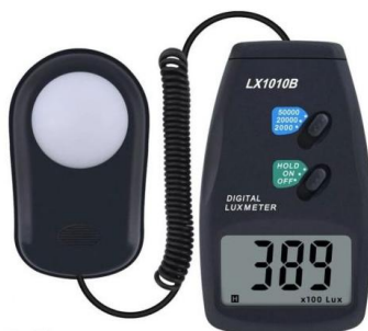
ภาพที่ 2.10 ลักซ์มิเตอร์ (Lux Meter) แหล่งที่มา: Comcube เว็บ (2565)
