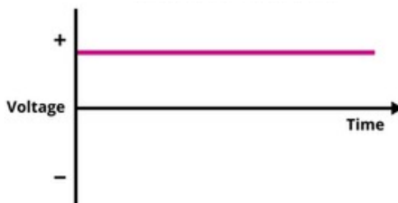
ภาพที่ 2.2 ไฟฟ้ากระแสตรง (Direct Current) แหล่งที่มา: ตำราฟิสิกส์เบื้องต้น (บรรจบ พลังงาน, 2561)
