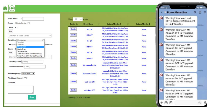
ภาพที่ 3.9 รูปแบบตั้งค่าการแจ้งเตือนผ่าน Line ให้แสดงผลในมือถือ แหล่งที่มา: Presentation Power Meter Line
